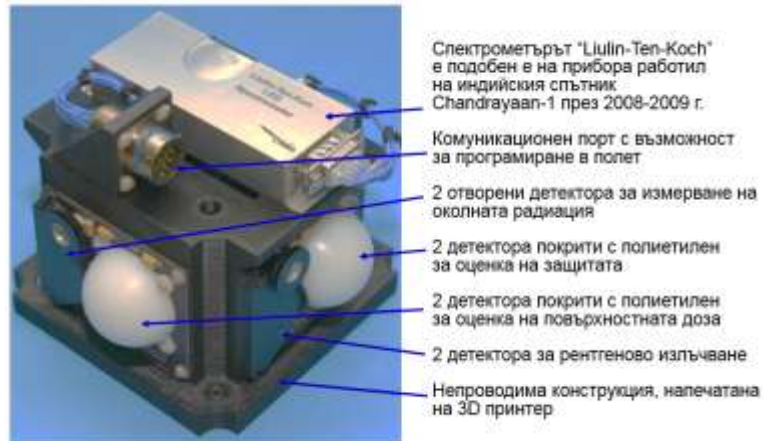
Фиг. 1. Приборът за заредени частици, разработен в университета Prairie View A&M, Тексас, САЩ и Джонсъновият космическия център на НАСА. Главен изследовател на експеримента е проф. П. Саганти. В горната част е спектрометърът "Liulin-Ten-Koh".
